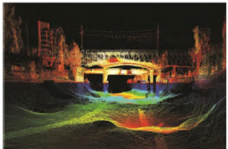
Merlin 水陸一体型レーザースキャナーとマルチビーム測深機の点群データをリアルタイムに統合したデータ例。水路両岸の構造物と、水路底の起伏が明瞭に記述されています。
