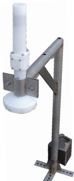
海底設置金具に取付けられた SL-501 型 超音波式砂面計
